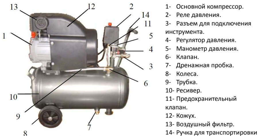
Рис. 1. Устройство компрессора
